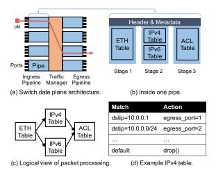
Figure 5: A primer on switch data plane.
